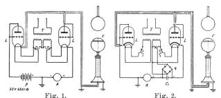
Schéma pour la mesure de la haute tension par courant capacitif redressé.
