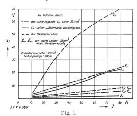
Spannungsabfall  $E_{\mathfrak{d}}$  im Polleiter und  $E_{\mathfrak{d}}$  im Nulleiter, bei einphasiger, ohmscher Belastung.
