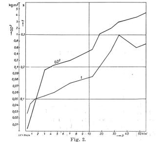
$GD^2$  und Eigenanlaufzeit (t) 4poliger Motoren mit Kurzschlussanker (50 Per./s) bei etwa 175% mittlerem Anlaufdrehmoment.
