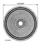
Fig. 2 (links). Schnitt durch das 220-kV-Oelkabel.
