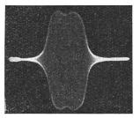
Fig. 3. Fig. 4. Kleinste Bandbreite und grösste Bandbreite der Resonanzkurve eines ZF-Transformators mit veränderlicher Bandbreite des Philips-Apparates 695 A.
