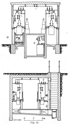
Querschnitte der Anlagen «Mattenbach» und «Rieter». Unten: Anlage «Rieter».
