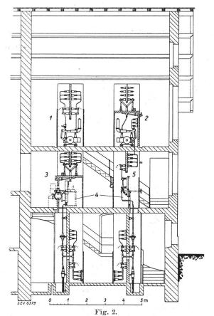
Querschnitt des Schalthauses.
