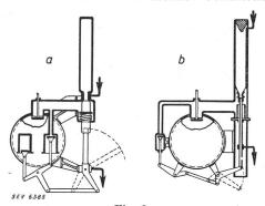
Prinzip der Arbeitsweise der Druckluftschalter von Brown-Boveri (a) und von MFO (b).
