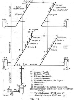
Schema der Druckluftverteilung.
