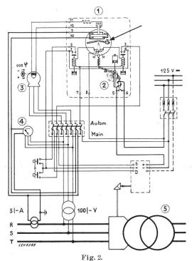
Réglage automatique de l'énergie réactive, par transformateur à prises supplémentaires, exécuté par MFO Zurich.
