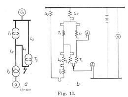
$\begin{array}{c} {\rm Messung \ am \ Modell.} \\ b \ {\rm Ersatzschema \ am \ Modell.} \end{array}$ Prinzip der
