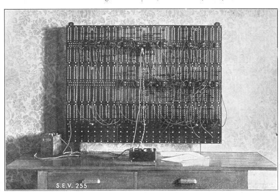
Fig. 12. Kurzschlussmodell des SEV.
