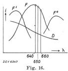
Zur Bestimmung der Spaltweitenkorrektur.
