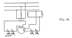
On pourrait obtenir aussi le même résultat en utilisant au lieu des machines en cascade, deux régulateurs d'induction par circuit, selon couplage de la fig. 26. Toutefois, le système de réglage serait également compliqué.
