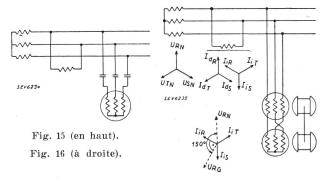
La machine doit absorber, comme dans le cas de la combinaison self-batterie, un système de courants inverses  $-I_{iR}$ ,  $-I_{iS}$ ,  $-I_{iT}$  égal et opposé au système de courants inverses de la charge monophasée; ou si l'on veut, on peut considérer, pour simplifier, la machine comme une génératrice et dire qu'elle doit fournir au réseau le système  $+I_{iR}$ ,  $+I_{iS}$ ,  $+I_{iT}$ .
