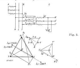
On veut connaître la dissymétrie en B. La centrale a une puissance de 1000 kVA; le four, de 500 kW sous  $cos \varphi = 1$  et 250 V. Rapportons les calculs à la tension secondaire composée de 250 V. Le courant du four soit 2000 A, se retrouve dans les enroulements des phases correspondantes primaires, mais transformé dans le rapport inverse du nombre de spires, c'est-à-dire devient  $\frac{1}{\sqrt{3}}$  ·2000 = 1150 A. Dans le
