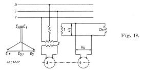
moteur synchrone monophasé 3 entraînant un alternateur 4 qui débite sur la charge monophasée Ch en parallèle avec le transformateur I. On cale la roue polaire de l'alternateur 4 de telle façon que la tension fournie à pleine charge aux bornes de cette machine,  $U_4$ , soit en phase avec la tension  $U_1$  aux bornes du transformateur I également à pleine
