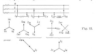
cisément à celui des courants inverses provenant d'une charge branchée entre R et S (voir fig. 13), et lui est opposé. Ce système de courants neutralise le système inverse de la charge  $I_{iR} \ldots$  et l'alternateur ne fournit plus que le système symétrique direct  $I_{dR} \ldots$
