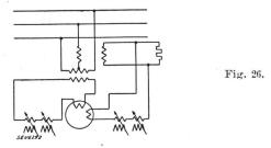
On pourrait obtenir aussi le même résultat en utilisant au lieu des machines en cascade, deux régulateurs d'induction par circuit, selon couplage de la fig. 26. Toutefois, le système de réglage serait également compliqué.
