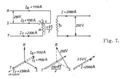
de 2000 A et les courants dans les phases R et T du réseau, de 2000 A.
