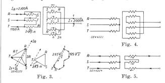
On peut se convaincre de même que le couplage de la fig. 4 est équivalent au couplage étoile/étoile. Avec le couplage de la fig. 5, les deux conditions élémentaires, à savoir:
