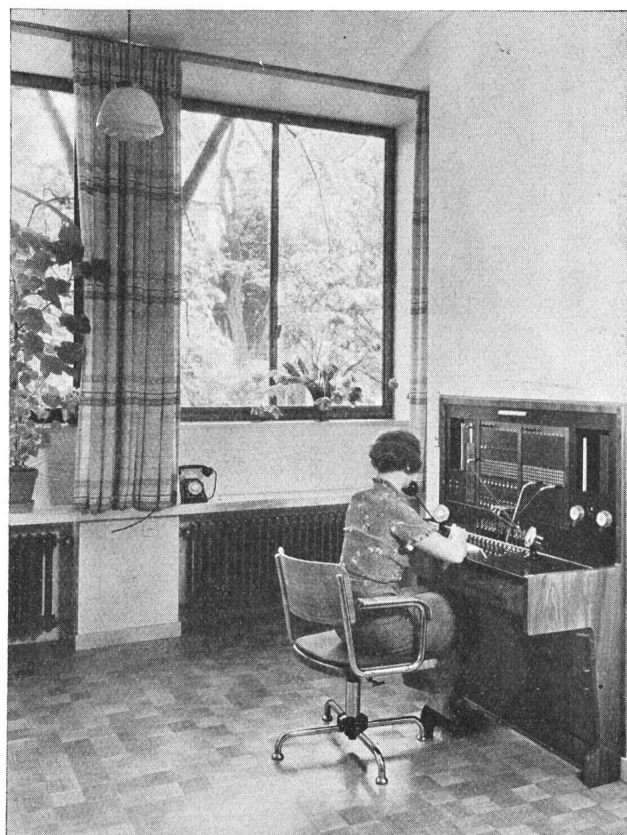
Vermittlerschrank für 40 Amtsleitungen
