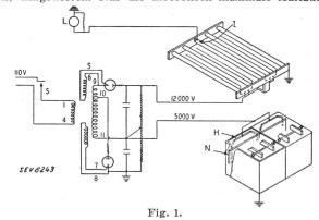
Schema des Elektrofilters mit Vor-Ionisierung.
