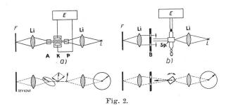
Bildempfänger. Prinzip der Kerrzellen- (a) und der Schleifenoptik (b).
