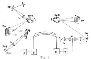
Prinzip der Fernsehübertragung mit Spiegelrad. L Lichtquelle. Sp Spiegel. Li Sammellinse. Ba Aufzunehmender Gegenstand. Be Empfangsbild. Ph-Z Photozelle. V Bildverstärker. S Hochfrequenz-Sender. E Hochfrequenz-Empfänger. KO Kerr-Optik. Sp-R Spiegelrad.
