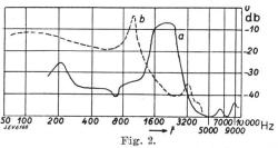
Frequenzkurve des Mikrophons Fig. 1 (a) und eines üblichen Telephons (b). (Ordinate mit relativem Maßstab.)
