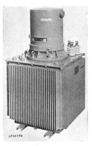
Fig. 5. Netzregler mit Induktionsreg-ler in Oel für Freiluftaufstel-lung 400 kVA, 400 V ± 5 %. In der Haube befindet sich das Spannungsrelais Fig. 7.
