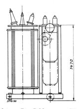
Autotransformator mit angebautem Stufenschalter, 250 kVA, 400 V, ± 6 % in 10 Stufen.
