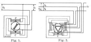
Schéma du régulateur monophasé (fig. 1) et triphasé (fig. 2).  $U_b$  tension brute.  $U_r$  tension réglée.
