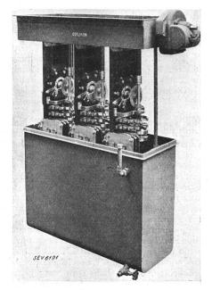
Fig. 1. Stufenschalter für  $\pm$  6 % in 10 Stufen.
