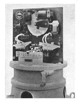
Fig. 7. Spannungsrelais eines Netzreglers mit Quecksilberschützen.
