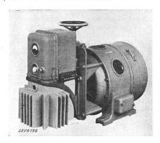
Fig. 10. Netzregler mit Antrieb durch Oeldruckspannungsregler, 20 kVA, 220 V  $\pm$  10 %.
