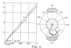
Spannungsverlauf des Reglers Fig. 4 in Funktion des Drehwinkels: 1 bei Leerlauf und 2 bei Belastung.
