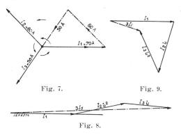
Exemple: Soient les 3 courants de 70, 60, 50 A, représentés par le diagramme fig. 7; ils fournissent pour la composante directe  $I_d = 59,7$  A, pour la composante inverse,  $I_i = 11,7$  A (Fig. 8 et 9). L'asymétrie est ainsi de:
