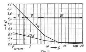
Fig. 2. Spannungsverlauf auf der Leitung bei minimaler (22 A) und maximaler (85 A) Belastung.
