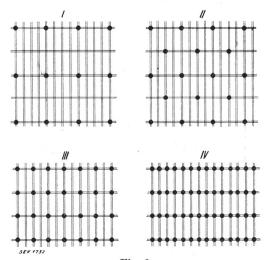
Fig. 2. Anordnung der Verteiltransformatoren für verschiedene
