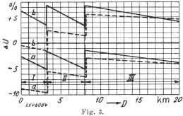
Abweichung  $\varDelta U$  der Spannungen in den Niederspannungsnetzen von der Nennspannung bei verschiedenartiger Belastung. Maximalbelastung. - - - - Minimalbelastung.
