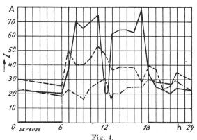
Gleichzeitige Belastungen verschiedener 8-kV-Leitungen eines Speisepunktes.
