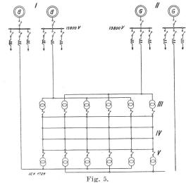
Vielfach gespeistes Wechselstrom-Niederspannungsnetz.
