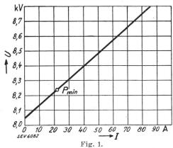
Spannungsregulierkurve: Regulierte Spannung U in Funktion der Leitungsbelastung I.
