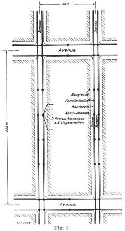
Anordnung der Niederspannungsverteiler für einen typischen Strassenblock.
