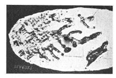
Fig. 7. Heizleiter-Längsschnitt, im Innern partiell geschmolzen.
