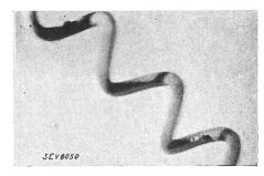
Fig. 2. Heizleiter, bis nahe an Schmelzpunkt erhitzt.
