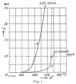
Ableitstrom I in Funktion der Kochplattentemperatur  $\vartheta$  bei Leergang und Prüfspannung 242 V, für Fabrikat X, Nennlast 1800 W, Prüflast 2180 W, und für Fabrikat Y, Nennlast 2300 W, Prüflast 2780 W, beide 22 mm Durchmesser, 220 V Nennspannung. Zulässiger Ableitstrom 10 mA.
