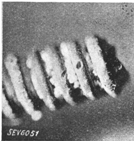
Fig. 3. Heizleiter, bis nahe an Schmelzpunkt erhitzt.
