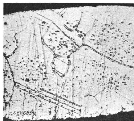
Fig. 6. Heizleiter-Längsschnitt mit Gefügeänderung, mässige Ueberhitzung.
