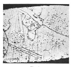
Fig. 6. Heizleiter-Längsschnitt mit Gefügeänderung, mässige Ueberhitzung.
