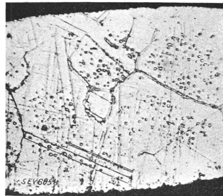
Fig. 6. Heizleiter-Längsschnitt mit Gefügeänderung, mässige Ueberhitzung.
