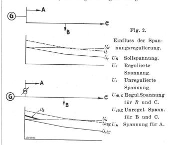
Liegen nicht mehr diese einfachen Verhältnisse der einzelnen Stichleitungen vor, sondern ein ganzes Netz, so wird das Problem kompliziert. Musste schon der Abnehmer am Anfang der einfachen Leitung mit einer Spannungserhöhung rechnen, so ist beim vermaschten Netz die Bildung eines gewissen Spannungsniveaus überhaupt unsicher, weil dieses sich unter dem Einfluss der Belastungsverhältnisse fortwährend verschiebt.
