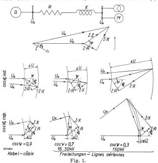
Spannungsabfall und Einfluss der Blindleistung.
