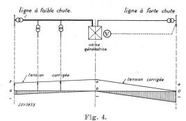
Réglage de la tension dans le cas de 2 lignes de caractéristiques différentes.
