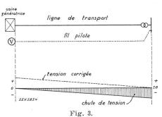
Réglage de la tension au moyen du voltmètre pilote.
