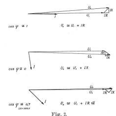
Diagramme dans le cas d'une ligne aérienne à moyenne tension.
