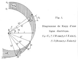
tension d'utilisation, en sorte que la tension à l'origine est plus grande qu'à l'extrémité. Ce phénomène se produit en particulier lorsqu'un câble ou une ligne à haute tension fonctionnent à vide; l'intensité qui parcourt la ligne est due au seul courant de capacité, qui se trouve ainsi en avance de 90° environ sur la tension génératrice.
