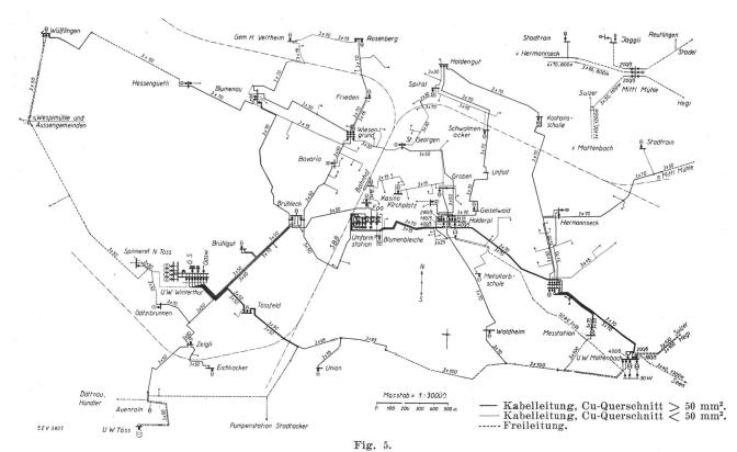
3 kV-Netz des EW Winterthur (gegenwärtiger Stand). Die grossen Punkte bedeuten Schalter mit Relaisschutz und die kleinen Punkte Abonnentenstationen.
