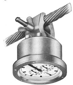
Fig. 6. Schwingungszähler, auf Leitungsseil montiert.
