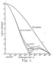
Strahlungsdiagramme verschiedener Antennenanord-
