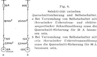
strom- und elektromagnetischer Schnellauslösung. Wird aber ein Selbstschalter mit nur thermischer Ueberstromauslösung benützt, so muss die in Fig. 7 gestrichelt gezeichnete Kurve betrachtet werden. Diese stellt die Zeit-Strom-Charakteristik eines Selbstschalters mit rein thermischer Ueberstromauslösung dar. Damit zwischen dieser Kurve und
