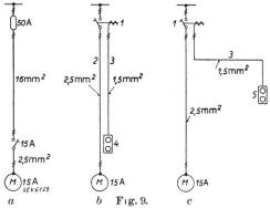
a Installation bei Verwendung von Hand-Motorschutzschalter.
