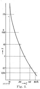
Zeit-Strom-Schmelzkurve einer Diazed-Sicherung, die dauernd mit 10 A belastet werden darf.
