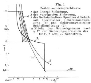
Schweiz meistgebrauchten Diazed-Sicherung und einer sogenannten verzögerten Sicherung und eine Zeit-Strom-Auslösekurve eines Selbstschalters mit thermischer Ueberstrom- und elektromagnetischer Kurzschlussauslösung aufgezeichnet.
