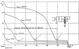
Fig. 5. Spannungsverteilung längs des Gleitrohres.
