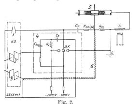
Schaltung der Messanordnung. 1 Strahlsperrplatten, 2 Zeitablenkplatten, 3 Ordinatenplatten, 4 Kipprelais, 5 Gleitrohr, 6 Messleitung.
