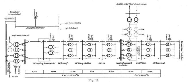
Schaltbild der geplanten Einphasensammelschiene für die Versorgung der Strecke Salzburg-Wien.
