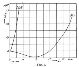
Aenderung der Eingangskapazität Co der DE 5- und der DE 5 B-Röhre in Funktion des Anodenstromes Ia bei änderndem Heizstrom  $I_f$  ( $U_a = 150 \text{ V}$ ,  $U_g = -1.5 \text{ V}$ ).
