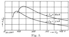
Aenderung der Eingangskapazität △Ce der LS 5-Röhre in Funktion der Anodenspannung Ua
