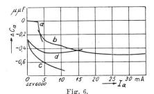
Aenderung der Anodenkapazität Ca der LS 5-Röhre in Funktion des Anodenstromes Ia
