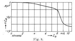
Aenderung der Anodenkapazität  $C_{\rm a}$  der O 30 B-Röhre in Funktion des Anodenstromes bei änderndem Heizstrom.  $(U_{\rm a}=220~{\rm V},~U_{\rm g}=-1.5~{\rm V}).$
