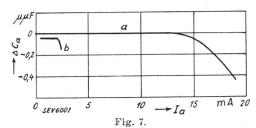
Aenderung der Anodenkapazität  $C_a$  der DE 5 (Kurve a)- und der DE 5 B (Kurve b)-Röhre in Funktion des Anodenstromes  $I_a$  bei änderndem Heizstrom ( $U_a=150~{\rm V},~U_g=-1.5~{\rm V}$ ).
