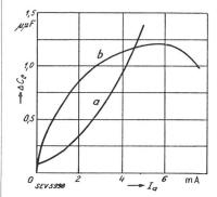
Fig. 4. Aenderung der Eingangskapazität ⊿C<sub>e</sub> der LS 5 B-Röhre in Funktion des Anodenstromes Ia.
