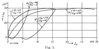
Aenderung der Eingangskapazität AC. der LS 5-Röhre in Funktion des Anodenstromes Ia
