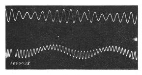
Fig. 10. Courant secondaire et courant d'excitation avec forte réaction.
