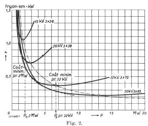
Coût unitaire x du transport d'énergie, compte tenu des pertes, en fonction de la puissance maximum P transmise au départ.
