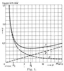
Coût unitaire x du transport d'énergie, par une ligne à 32 kV,  $3\times70~\rm mm^2$ , en fonction de la puissance maximum au départ P.
