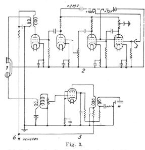
Schaltschema der Sende- und Empfangseinrichtung. 1 Telephonhörer. 2 Empfangsverstärker. 3 Photozelle. 4 Krater Neonlampe. 5 Sendeverstärker. 6 Zum 400-Volt-Gleichrichter.
