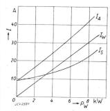
Fig. 3. Stromverteilung im Aggregat in Funktion der vom Wasserwiderstanden aufgenommenen Leistung  $P_{W}$  bei n = 1000/min.
