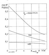
Fig. 6. Verlauf des  $\cos \varphi$  (kapazitiv) an der Synchronmaschine in Funktion der vom Wasserwiderstand aufgenommenen Leistung  $P_{\mathbf{W}}$ .
