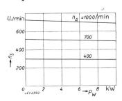
Fig. 5. Verlauf des Schlupfes zwischen Synchron- und Asynchronmaschine: Drehzahl der Synchronmaschine  $n_s$  in Funktion der vom Wasserwiderstand aufgenommenen Leistung  $P_w$  bei verschiedenen Drehzahlen der Asynchronmaschine  $n_A$ .
