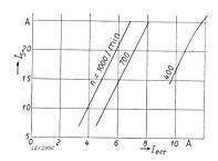
Fig. 4. Stromverlauf in der Synchronmaschine  $I_S$  in Funktion des Erregerstromes  $I_{\rm eff}$  bei verschiedenen Drehzahlen  $n=1000,\ 700\ {\rm und}\ 400/{\rm min}.$
