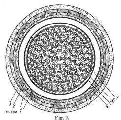
Coupe du câble (grandeur naturelle). 1 Jute asphalté. 2 Fers méplats, zingués 1,2 mm. 3 Fers méplats, zingués 1,7 mm. 4 Papiers bitumés. 5 Gaine de plomp (1% Sn) 3 mm. 6 Ruban en coton. 7 Spirale en acier SM 6×1 mm.
