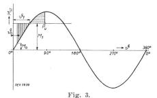
Bestimmung der Ueberschwingung des Polrades eines Synchronmotors, dessen Belastungsmoment plötzlich von  $M_0$  auf  $M_1$  gesteigert wird.
