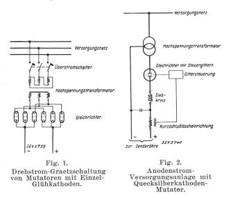
Der innere Spannungsabfall (Brennspannung) dieser Mutatoren beträgt, unabhängig von der Höhe der Betriebsspannung, für welche sie gebaut sind, nur 15 bis 25 V. Sie arbeiten ohne besondere Wartung mit grosser Betriebssicherheit. Ganz besondere Vorteile aber bieten die gittergesteuerten Entladungsgefässe durch die einfache Möglichkeit der Spannungsregulierung und der nahezu trägheitslosen Abschaltung der Gleichstromversorgung bei Kurzschlüssen an den Senderöhren.
