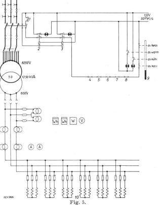
Prinzipschema der Trester-Trocknungsanlage.
