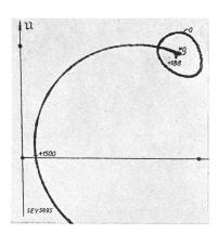
Fig. 8. Photographische Aufnahme der Ortskurve des Ständerstromes eines 4poligen Drehstrom-Kurzschlussmotors mit 36 Nuten im Ständer und 32 Nuten im Läufer. Der kleine Kreis  $(n = 0/\min)$  wurde bei sehr langsamer Verdrehung des Läufers um eine Läufernutteilung aufgenommen.
