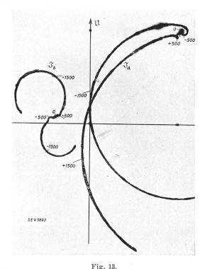
Photographisch aufgenommene Ortskurven eines nach Fig. 11 geschalteten Einphasen-Kondensator-Motors. Ja Strom der Hauptwicklung, Jb Strom der Hilfswicklung.
