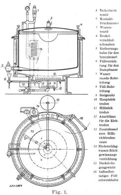
Schnitt durch einen Elektroden-Kochkessel.
