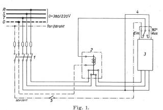
Schema zur Steuerung von Heisswasserspeichern durch Tarifdraht.
