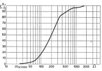
Fig. 2. Häufigkeitssummenkurve der Fahrdrahtimpedanzwerte im Frequenzbereich von 150 bis 1500 kHz.
