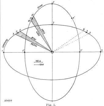
Spannung- und Strom-Diagramm der verlustlosen Leitung in richtiger gegenseitiger Lage.
