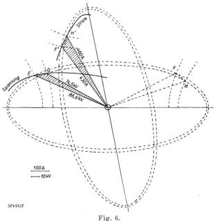
Spannungs- und Strom-Diagramm der Leitung mit Verlusten in richtiger gegenseitiger Lage.
