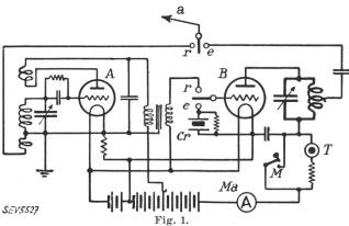
Schéma d'une station radiotélégraphique émettrice-réceptrice portative. (r = position réception; e = position émission.)
