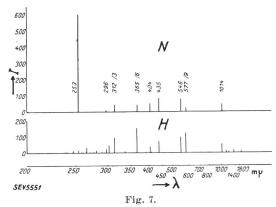
Energieverteilung im Spektrum der Quecksilber-Niederdruck-(N) und der Quecksilber-Hochdruck-Lampe (H) bei gleicher Gesamtstrahlung.
