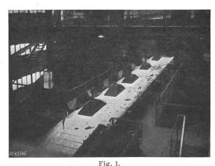
Leseband eines Steinkohlenbergwerks, beleuchtet mit 5 Quecksilberdampflampen 280 W.
