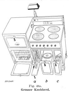
mit 4 Platten, 2 Backöfen, 1 Rostofen (a), 1 Selbstkocher (b) und einer Schublade (c), ferner mit Herdlampe, Temperaturregler und Schaltuhr für Platte oder Backöfen. Die Backöfen besitzen Innenbeleuchtung.
