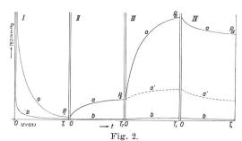
Pression résiduelle mesurée sur le câble, courbe a, et sur le tuyau, courbe b.
