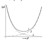
Fig. 7. Variations des pertes d'un câble en fonction de la température. 1 Pertes totales. 2 Pertes dues à la conduc-
