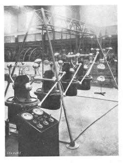
Fig. 9. Générateur à courant continu 450 kV.
