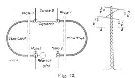
Schéma de l'installation des câbles à huile, à Vernayaz. Les chiffres placés en regard des phases indiquent le nombre de contournements causés par la foudre pendant les étés 1929 et 1930.
