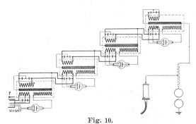
Schéma de fonctionnement du générateur à courant continu 450 kV de la Compagnie Générale de Radiologie, Paris. 1 Vers le pupitre de commande.
