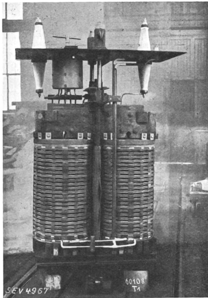
Fig. 15. Ansicht des aktiven Teiles einer Löschspule.
