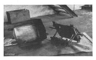
Fig. 4. Reste des ausgebauten Schalters.
