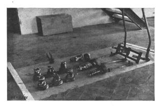
Fig. 5. Reste des über dem Schalter Fig. 3 eingebauten Trenners.
