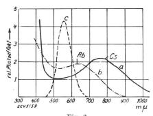
Fig. 2. Spektrale Empfindlichkeitsverteilung der verwendeten Kathoden.
