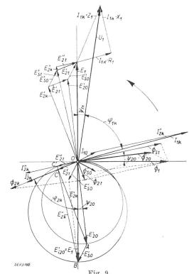
Vollständiges Diagramm des Streutransformators bei Kurzschluss.
