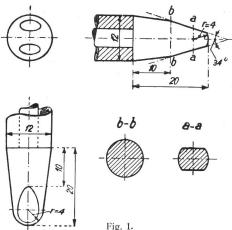
Tastfinger für die Prüfung der Berührbarkeit unter Spannung stehender Teile.
