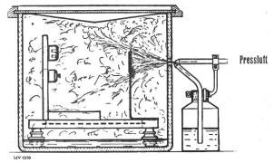
Fig. 5. Abschlusskasten und Zerstäuber für die Prüfung der Feuchtigkeitsbeständigkeit.
