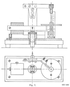
Apparat für die Durchführung der Prüfung der Feuersicherheit
