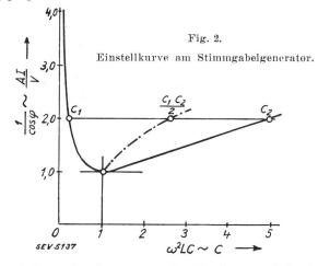
stant gehaltener Anodenspannung den Kondensator C durchzudrehen, gleichzeitig den Schwingstrom  $\mathfrak{F}_1$  zu beobachten und findet beim minimalen  $\mathfrak{F}_1$  den Betriebspunkt mit phasenreiner Rückkopplung.
