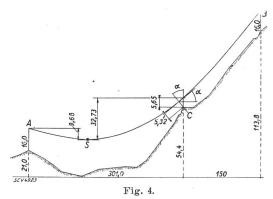
dass die maximale Zugspannung im ungünstigsten Fall (0° und 2 kg/m Schnee) höchstens 85 % der nach Starkstromverordnung zulässigen Höchstbeanspruchung von 1800 kg/cm² beträgt. Es ist der Abstand des Leiters von dem vorspringenden Geländepunkt C am obern Strasseneinschnitt bei 0° und 2 kg/m Schnee zu bestimmen.
