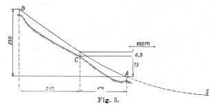
Die Differenz zwischen angenäherter Berechnung und genauer Berechnung nach Kettenlinie beträgt bei diesem Beispiel nur 9 cm; die Uebereinstimmung ist um so besser, je kleiner die Spannweite und je grösser der Parameter der Kurve sind.
