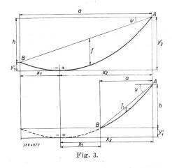
meters meist zu ungenau ist. Die Aufgabe lässt sich aber mit guter Näherung für Spannweiten bis 400 m und Neigungswinkeln bis 30° folgendermassen lösen:
