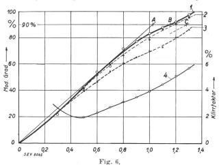
Modulationskennlinien und Klirrfaktoren
