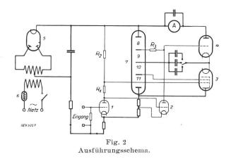
5000 Ohm und die Messgenauigkeit  $\pm 2\,\%$  beträgt. Bei nicht sinusförmiger Wechselspannung wird die Frequenz der Grundschwingung noch genau angezeigt, wenn der Anteil der doppelten Grundfrequenz 50 % und derjenige der dreifachen Grundfrequenz 33 % (bezogen auf die Grundwelle) nicht überschreitet. Hartmut Keller.
