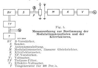
b) Der Frequenzgang der Modulation wird nach der Schaltung von Fig. 7 dadurch aufgenommen, dass an den Eingang des B-Verstärkers eine konstante Spannung veränderlicher Tonfrequenz angelegt wird, und der jeweilige Modulationsgrad durch Messung des Antennenstromes nach der Heisingmethode bestimmt wird. Die Veränderungen des Modulationsgrades ausgedrückt in Dezibel über der logarith-
