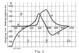
Impedanzkurven der Antenne nach Fig. 1, zwischen Antenne und Erde gemessen.
