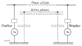
Fig. 3. Fonctionnement du système unifilaire.
