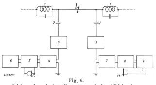
Schéma de principe d'une transmission téléphonique.
