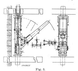
Aeltester Oelschalter (Topfschalter) von Ferranti (1895). (Aus Vogelsang: Geschichtliche Einzeldarstellungen aus der Elektrotechnik, Berlin 1929.)
