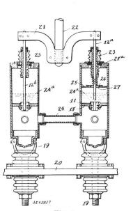
Fig. 8. Topfschalter mit abgestufter doppelter Unterbrechung, Brit. Thomson Houston (1905). (Aus British Pat. 24 853/1905.)
