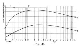
Kurve der Lichtbogenlänge eines Wasserschalters in Funktion
