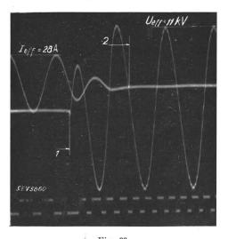
Fig. 33. Oszillogramm einer Widerstands-Abschaltung von 28 A beim Wasserschalter Oerlikon, 10 kV, 600 A. 1 Beginn der Oeffnung des Kontaktes. 2 Ende der Abschaltung.
