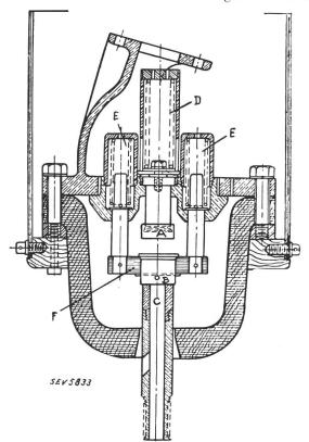
Fig. 14. Schnitt durch eine Oelabblaskammer der G. E. Co.
