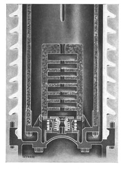
Fig. 36. Prinzipieller Schnitt durch die Löscheinrichtung des ölarmen Schalters Brown Boveri (Konvektorschalters).
