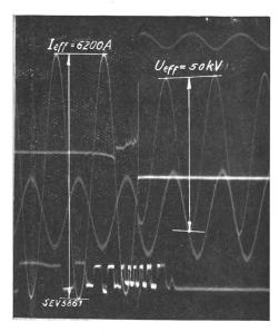
Fig. 42. Oszillogramm der Abschaltung einer dreiphasigen Leistung von 620 MVA bei 50 kV mit einem ölarmen Schalter Oerlikon.
