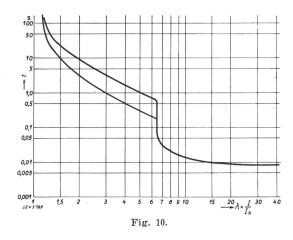
Logischerweise sind nach Gl. (35) und (36) zwei verschiedene Temperaturen  $\vartheta_m$  und dementsprechend zwei verschiedene Kurzschlußströme für ein und denselben Bimetallstreifen vorhanden, je nachdem dieser kalt oder betriebswarm ist.
