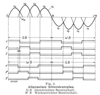
riegelung der einzelnen Kurzschlusswege. Die Verriegelung ist in einfacher Weise herbeizuführen mit einer derartigen Einwirkung auf die Gittersteuerung, dass beide Gefässgruppen, d. h. die Gruppe 1'...3' bzw. 1"...3", einander in der Stromführung ausschliessen: die Gittersteuerung ist so ausgebildet, dass, solange ein Gefäss der einen Gruppe Strom
