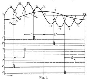
Gittersteuerplan bei induktiver Belastung.
