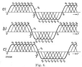
Aenderung der Frequenz der Sekundärspannung.
