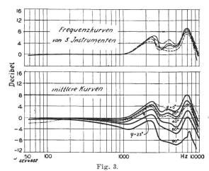
Frequenzkurven von elektrodynamischen Mikrophonen.
