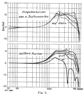
Frequenzkurven von Kondensator-Mikrophonen.
